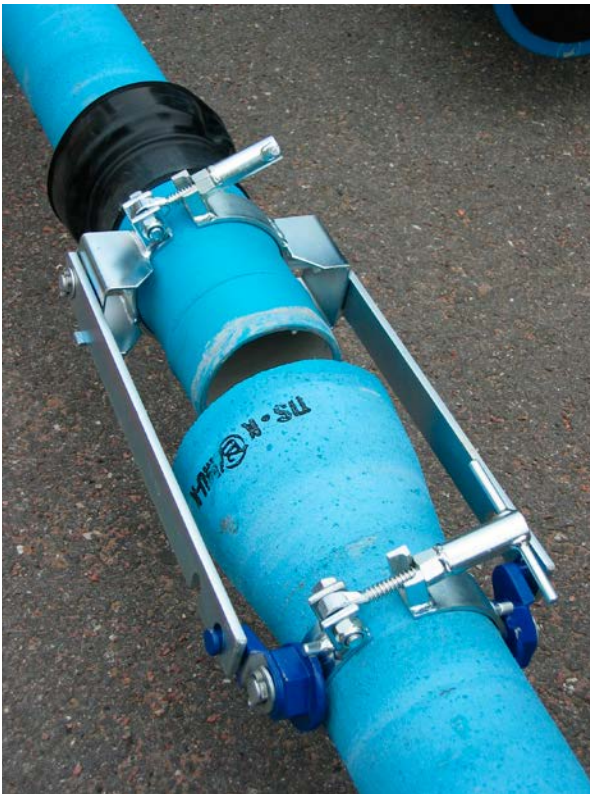
Kuva 8. Asenna asennustyökalun sininen osa muhvin puolelle ja toinen pää pistopäähän.
