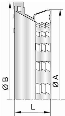
Die Verbindung UNIVERSAL NOVO-SIT ist eine längskraftschlüssige Rohrverbindung mit separatem Haltering. Durch die Reibschlüssigkeit des mit Hartmetallzargen ausgestatteten Halterings NOVO-SIT wird die Längskraftschlüssigkeit gewährleistet. Die TYTON Dichtung oder Die STANDARD Dichtung erfüllt die Dichtfunktion.
