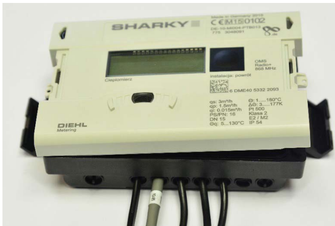
Kuva 5.8 – Kannen sulkeminen vasemmasta reunasta alkaen
