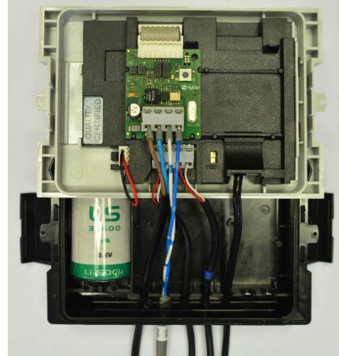
Kuva 5.6 – Esimerkki oikein johdotetusta modulista.
