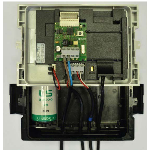
Kuva 5.4 – Syöttöjännitteen kytkentäesimerkki
