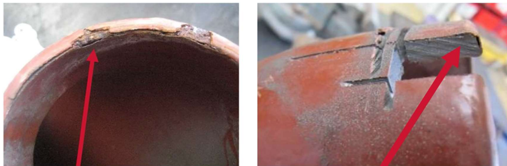
Kuva 2. Silmämääräisesti huolestuttavan näköinen kohta osoittautui poikkileikkauksessa ainoastaan kosmeettiseksi.
